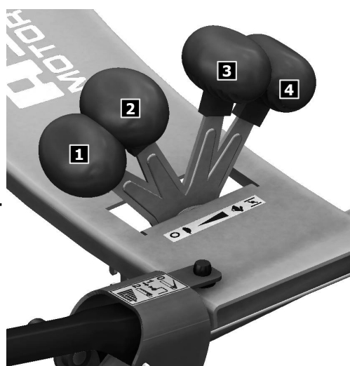
Obr. 8: Polohy páčky akcelerátoru
